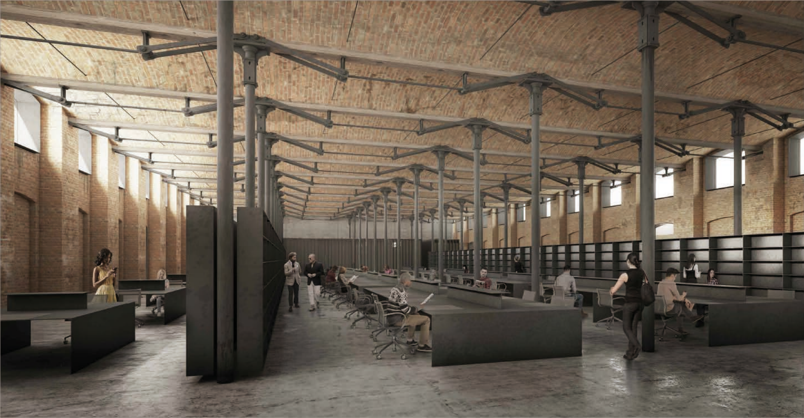
IMATGE INTERIOR SALA CONSULTA Es dissenya l'edifici respectant els materials originals. Es manté la totalitat de l'estructura de la planta baixa per preservar els seus valors patrimonials així com la seva qualitat espacial i estructural.
