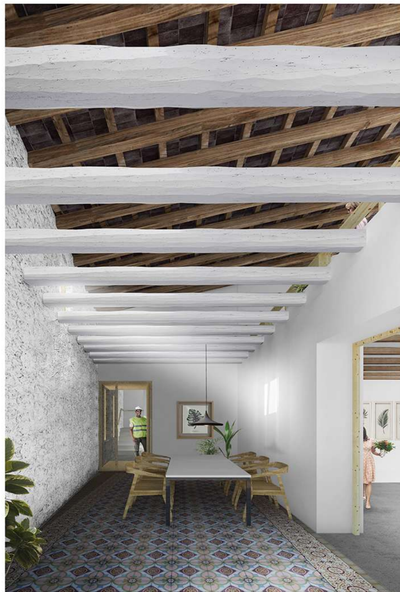
Caràcter de l'espai interior. Degut al peu galib de la planta sotacoberta, la sala de reunions es configura en doble espai, respectant les bigues a l'alçada original i tractant l'entretibat. Es restauren i posen en valor els paviments i acabats interiors.
