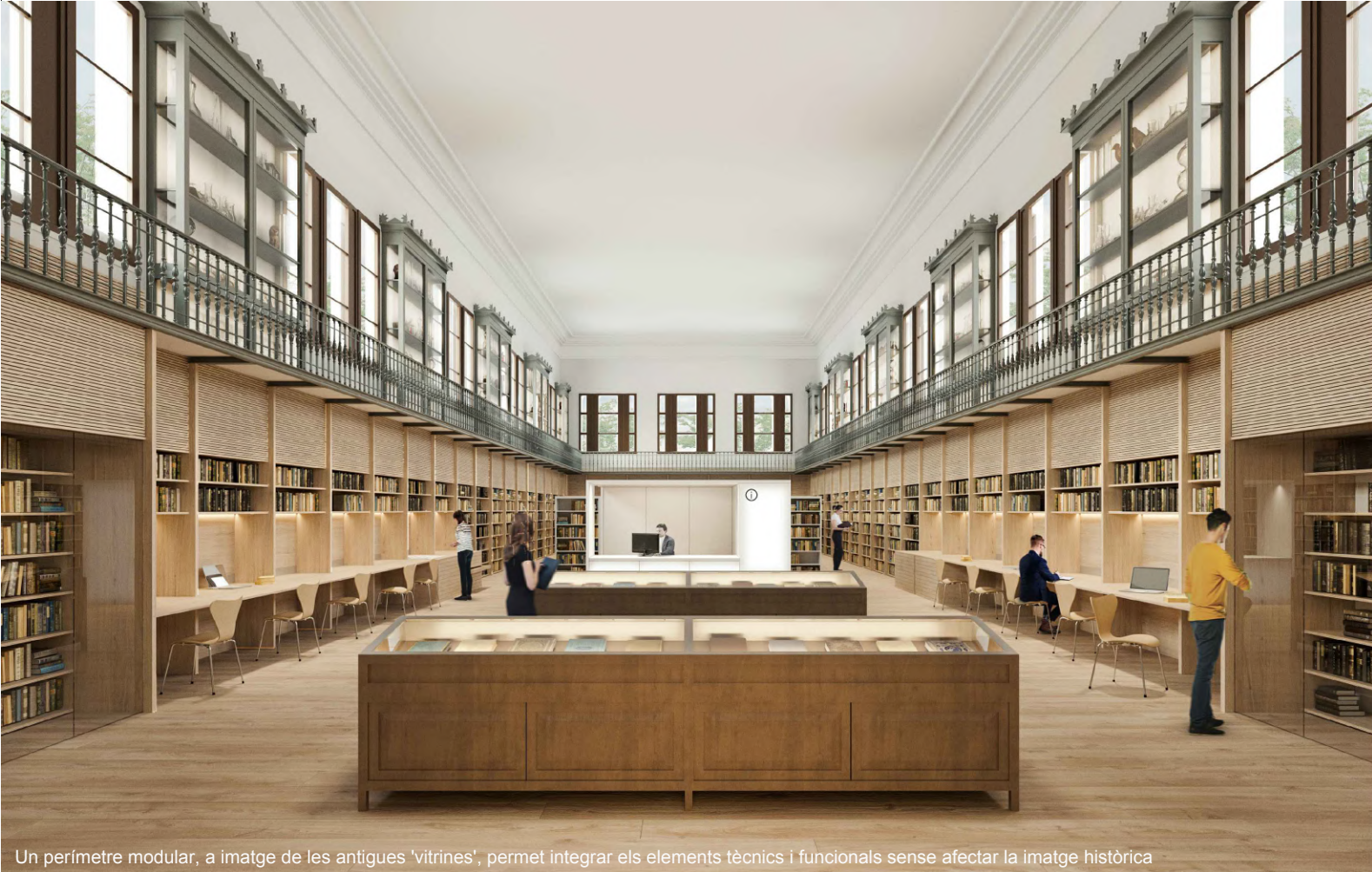
Un perímetre modular, a imatge de les antigues 'vitrines', permet integrar els elements tècnics i funcionals sense afectar la imatge històrica
