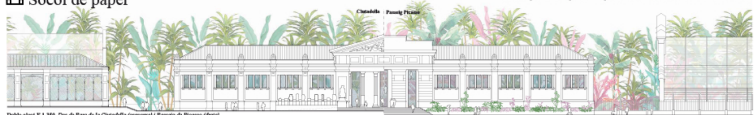
Doble alçat E 1.350 Des de Pare de la Ciutatella (esquerra) i Passatge de Picasso (dreta). Verticalització d'obertures en façanes del cos central permetibilitzen i apropren la institució a la ciutatana. Nou accés a la Ciutatella
