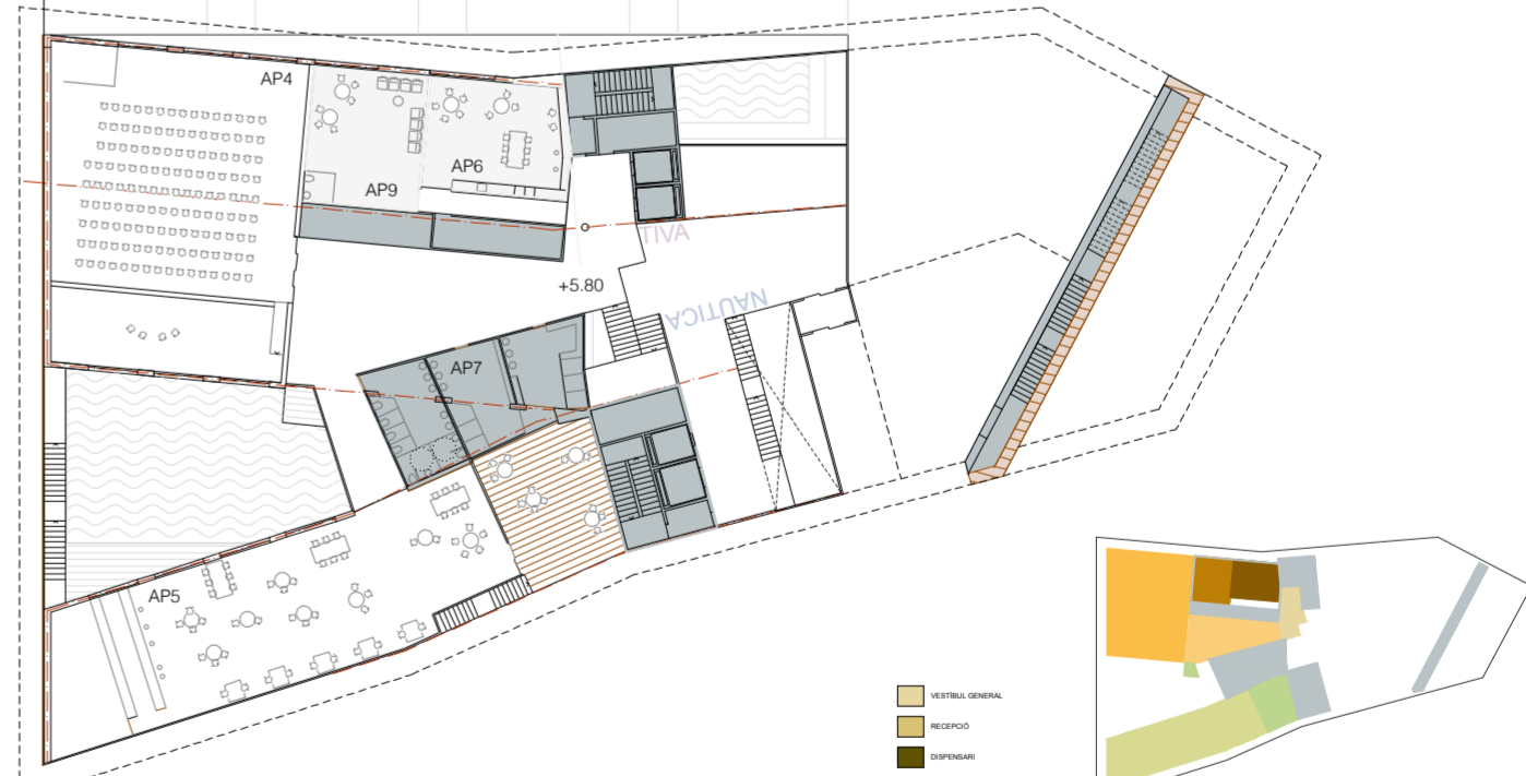
Planta Soterrani (cota -1.75) Programa d'Ús conjunt i Facultat Nàutica UPC e: 1/500 A11 Vestidors personal serveis A12 Magatzems de neteja de l'edifici A13 Sales d'instal·lacions A14 Taller de manteniment A15 Estació transformadora A16 Estació central de seguretat LB1 Lab. Màquines i motors tèrmics LB2 Lab. Enginyeria i contrucció naval E12 Canal d'experiències hidrodinàmiques E13 Túnel de vent
