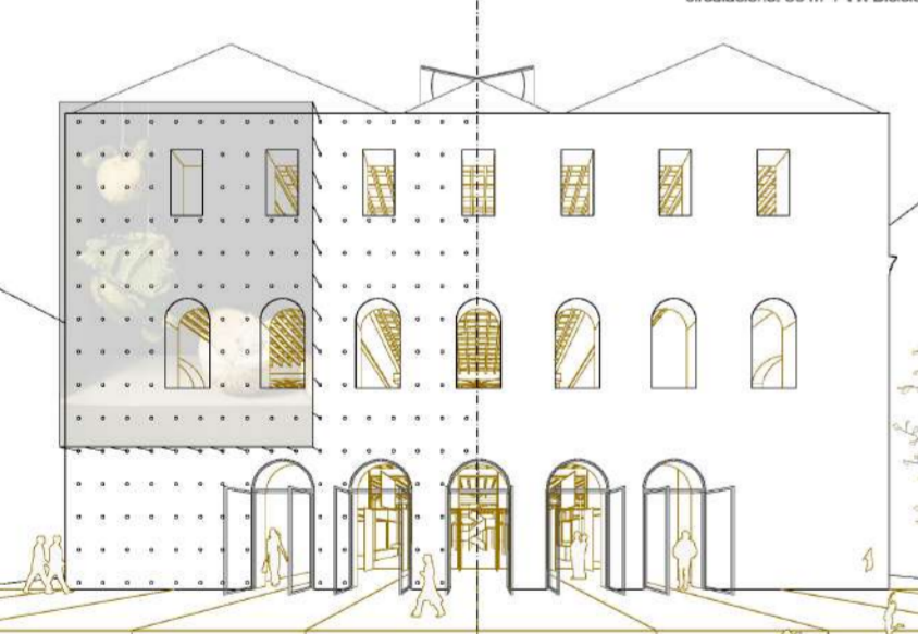
> Alçat nord-oest | e:1/250 La façana com a llenç: sistema modular i reversible d'elements de suport d'obres d'art temporals
