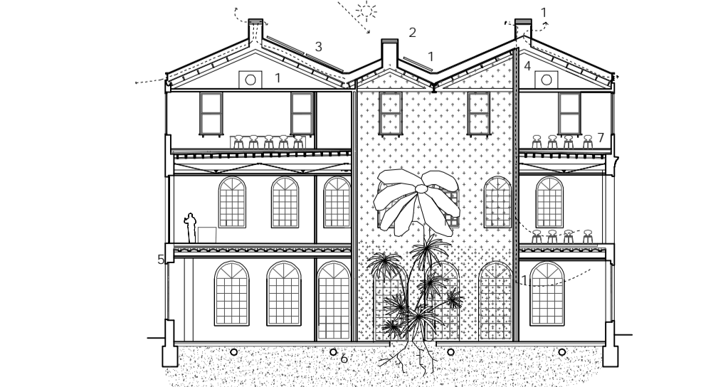
Secció B 1:300 1. Sistema de coberta ventilada 2. Lluernari 3. Plaques solars 4. Aire pretractat i que es porta de forma mecànica a la coberta i un sistema de fan-coils completa el nivell de temperatura de cada espai de forma específica en funció de les demandes 5. Neteja i aplicació de morter de calç. Recuperació d'obertures originals 6. Geotèrmia superficial. Climatització passiva de la plaça amb sistema de tubs canadencs amb capa antimicrobiana 7. Paviment + aïllament tèrmic
