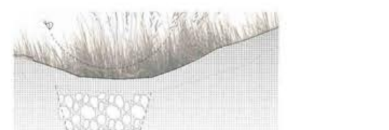
Cubetes de drenatge.
