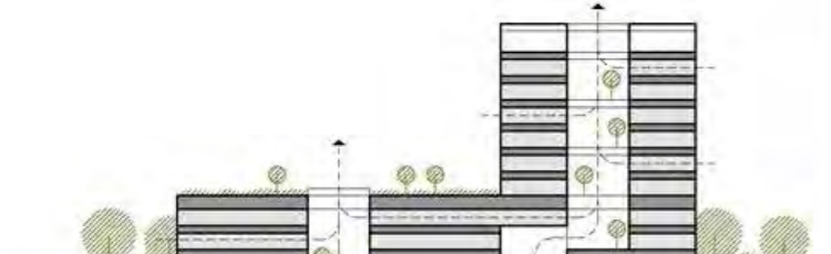
secció bioclimàtica en atris amb ventilació creuada
