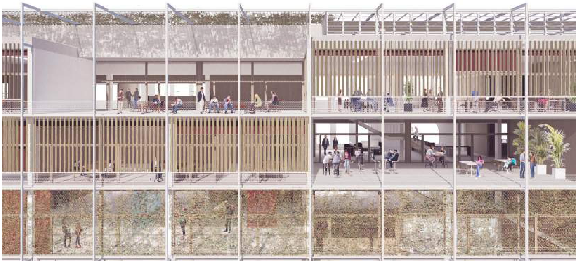
La façana es un sistema viu i canviant, amb gruix, que incorpora terrasses i porxos. Un element de transició i control ambiental que proporciona gran qualitat als espais de treball interiors
