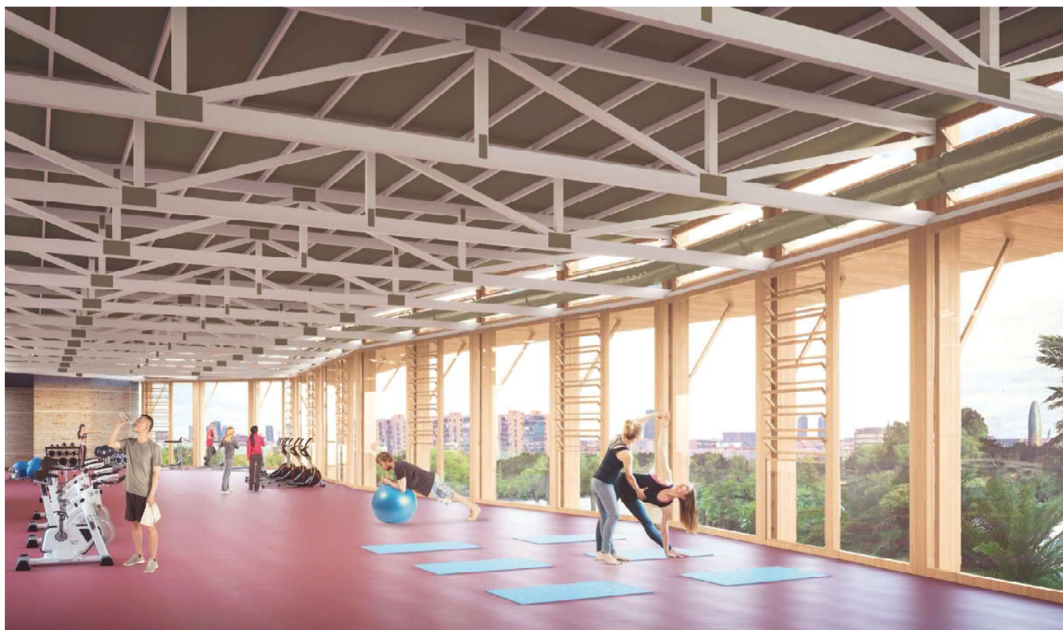
La sala de fitness: espai diàfan i flexible amb vistes a la ciutat i al Parc de la Sagrera. S'aconsegueix el confort climàtic per mitjà de la ventilació creuada, un ràfec com a protecció solar i alta inèrcia tèrmica gràcies al mur de terra.
