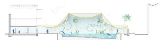
Piscines Indoor: Cubrició temporal amb el sistema "Haima" de teixit tensat.
