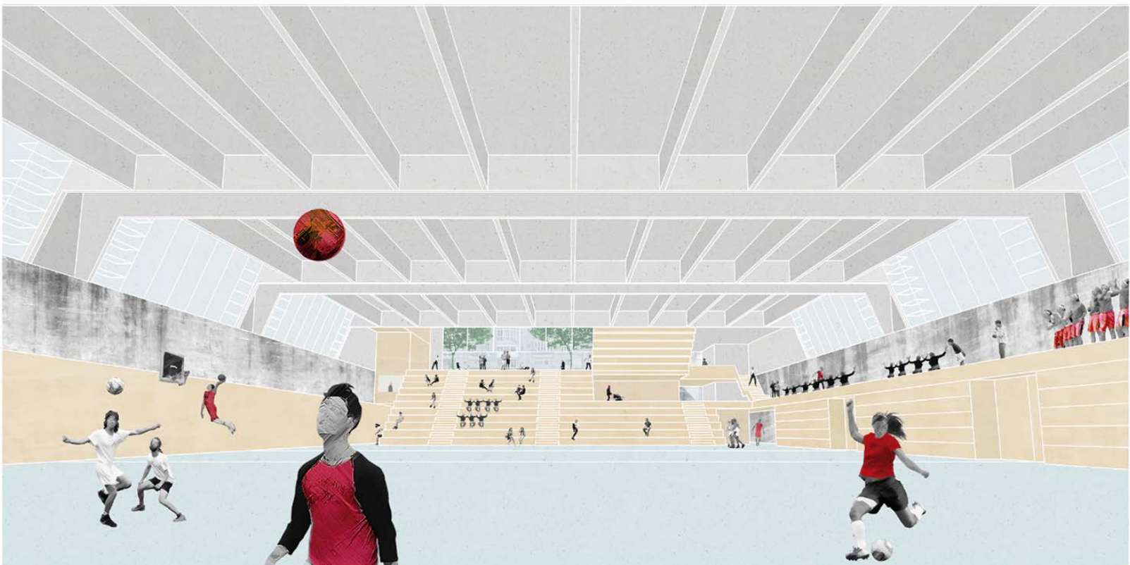
PAVEL·LÓ ESPORTIU (PAV3). (-6,00). El PAV és un espai molt permeable des del carrer, prolongant l'espai públic fins a peu de pista. La llum entra pels quatre costats de forma natural i uniforme, entrant pels plans verticals per evitar sobre costos, optimitzant la construcció i permetent ventilació creuada. La grada del PAV és lateral amb unes visuals isotèpiques òptimes, i a sota s'hi amaga passadís d'accés i les grades retràctils. Es proposa una grada al lateral accessible des del vestíbul plaça i carrer, un lloc memorable que ofereix un gran espai públic molt generós (a imatge de Piazza Spagna, Roma), el que permet una gran polivalència d'ús del PAV, p.e. per a un escenari.
