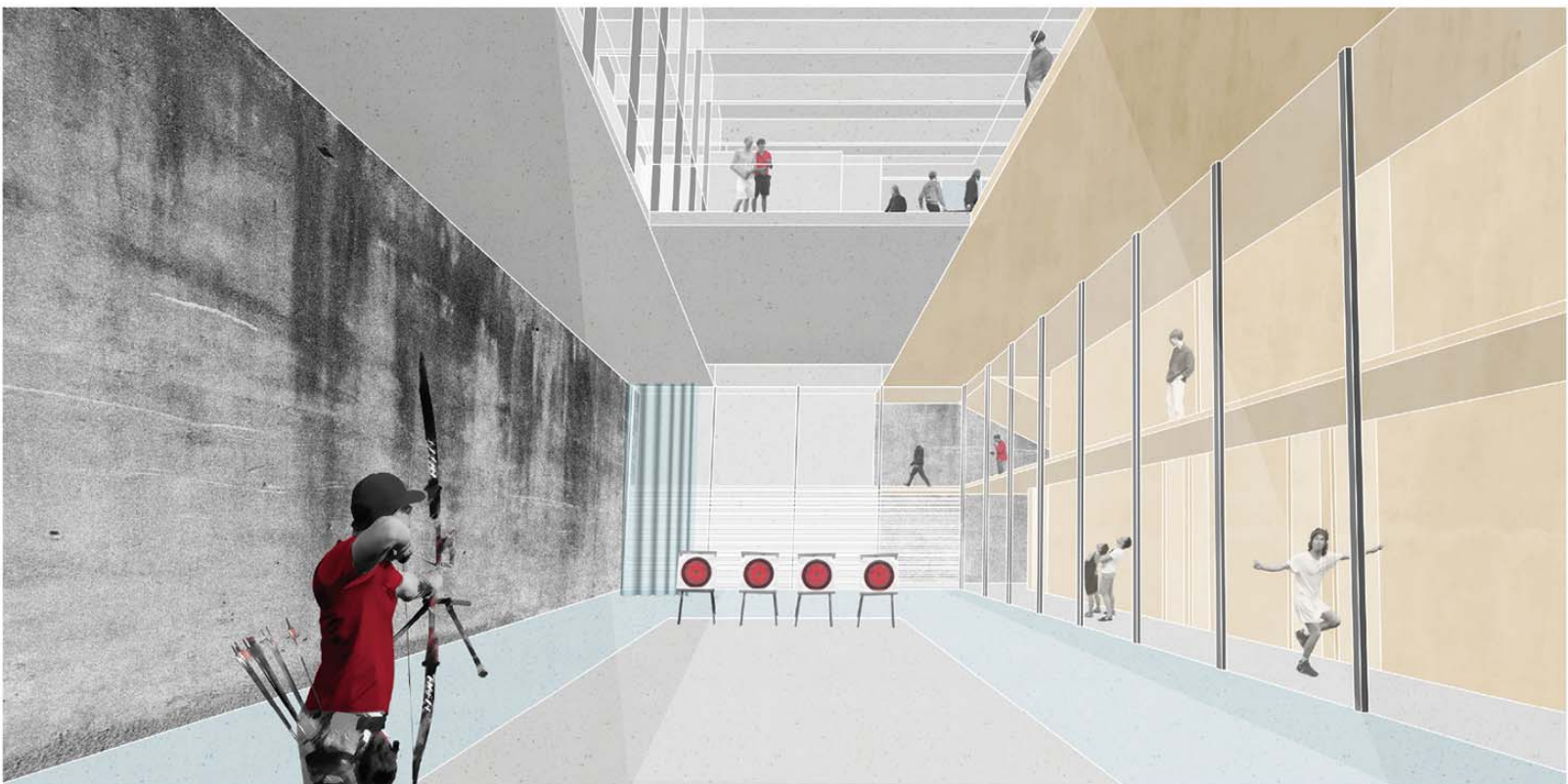
TIR AMB ARC (-6,00). Una alçada molt per sobre de la mínima normativa ofereix un espai polivalent de molta qualitat i el relaciona amb els accessos a vestuaris, vestíbul i carrer. Aquí s'endevina el canvi d'estructura: vas d'excavació i pantalles de formigó fins cota, i estructura mixta metàl·lica i fusta en plantes superiors. Al fons, el nucli d'evacuació permet una ràpida fugida en cas necessari. L'alçada i posició de la pista afavorirà una potencial polivalència d'ús a futur.
