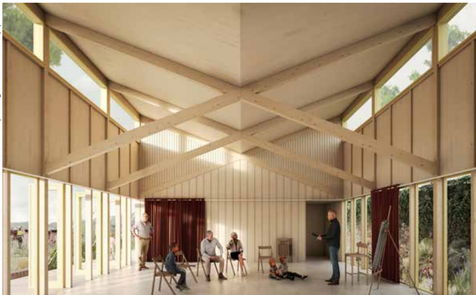
La sala polivalent té un sistema de bigues de fusta en forma de M que permeten cobrir un llum de 8m i al mateix temps configurar una coberta de papallona.
